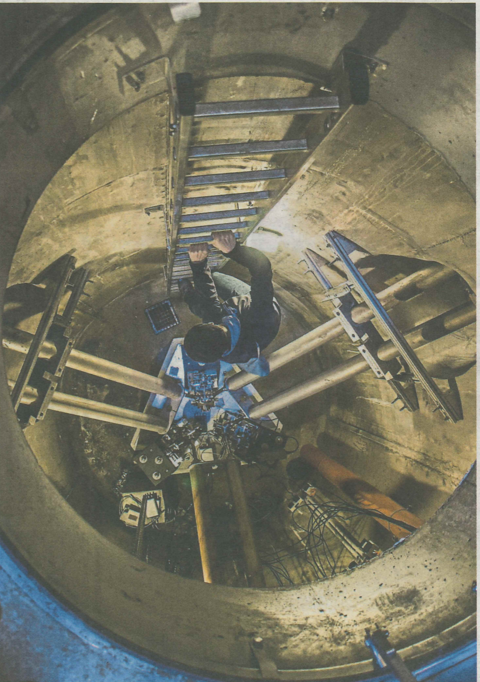
Der Ring-Laser ist so groß wie ein dreistöckiges Haus. Er hilft bei der Erdbebenfrüherkennung.
